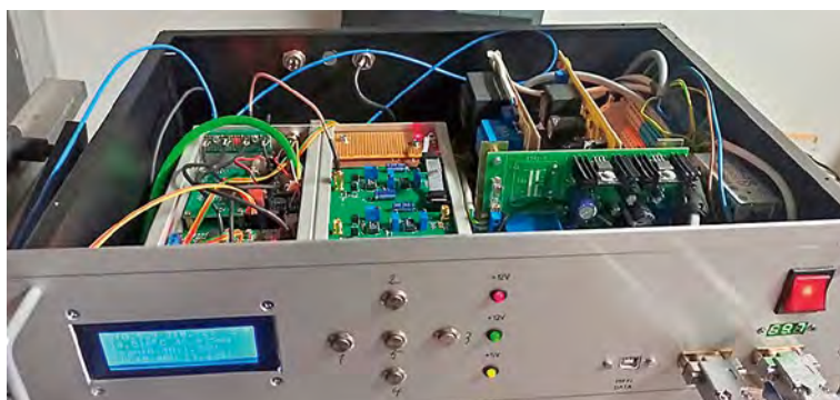
Abb. 2 Kompaktes Mikrocontroller-System mit integriertem Lock-In-Verstärker.
