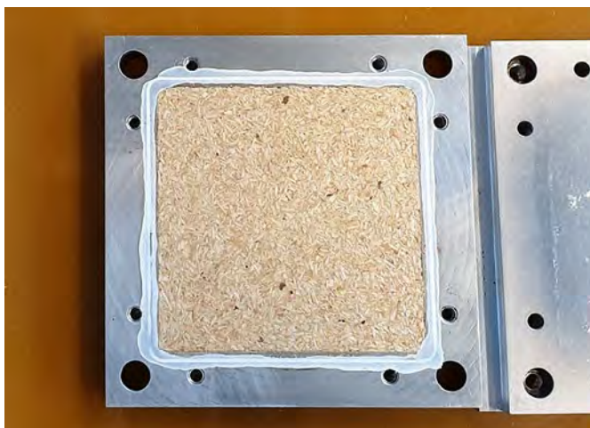
Abb. 2 Erste RPC-Platte (Recycled Particle Composite-Platte) aus unbehandeltem Holz für Untersuchungen.
