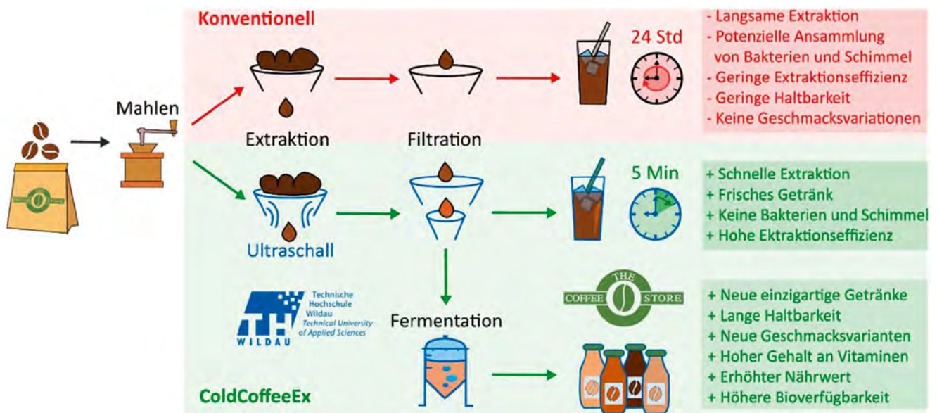
Abb. 1 Schema der geplanten Verfahrensentwicklung für eine effiziente Kaltextraktion und die Entwicklung verschiedener Cold Brew-Getränkevarianten.
