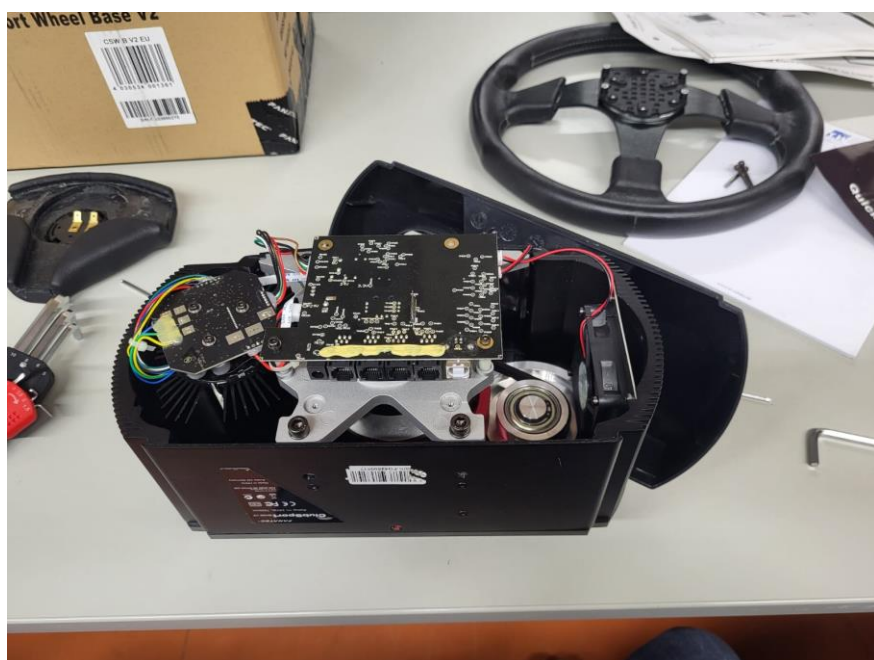
Lenkradbasis mit Motor und Steuerungselektronik
