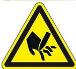
Beim Bohren Schutzausrüstung tragen. Enganliegende Kleidung tragen, Ärmel nach innen umschlagen. Langes Haar schützen (z.B. durch Mütze, Haarnetz). Niemals Handschuhe tragen. Ringe, Ketten, Armbanduhr oder ähnliche Gegenstände vor Arbeitsbeginn ablegen. Beim Bohren spröder Werkstoffe Schutzbrillen benutzen.
